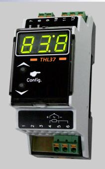
Le THL37 est un thermostat compact, destiné à la régulation d'éléments chauffants (câble, ruban) permettant la commande directe de charge résistive jusqu'à 4.5 Kilowatts. La régulation numérique permet d'allier précision et facilité de réglage, la température et la consigne sont affichées sur un large afficheur à LED
